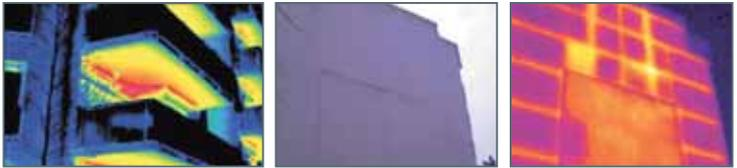
Détection de déperdition thermique à l'aide d'une caméra thermique.
