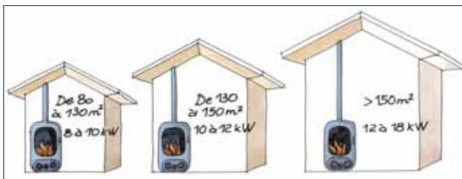
Puissance moyenne des chaudières à bois en fonction de la surface à chauffer
